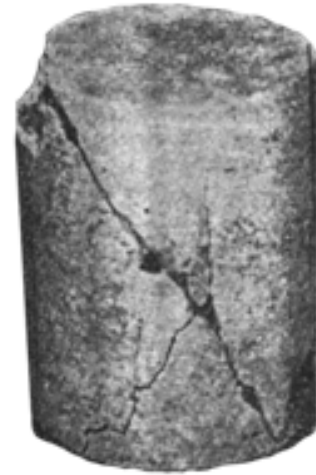
Рисунок 1 – Зразок клинової форми руйнування за Л.І. Бароном
